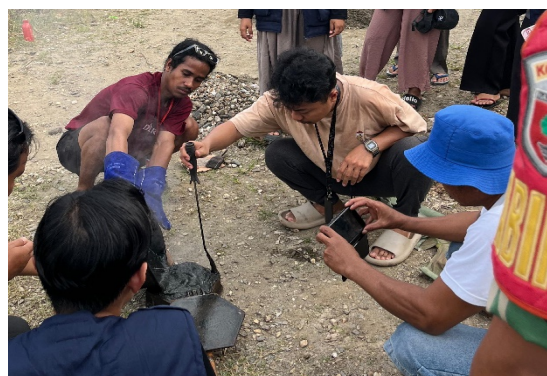
Gambar 3. Pengepressan adonan dalam cetakan
