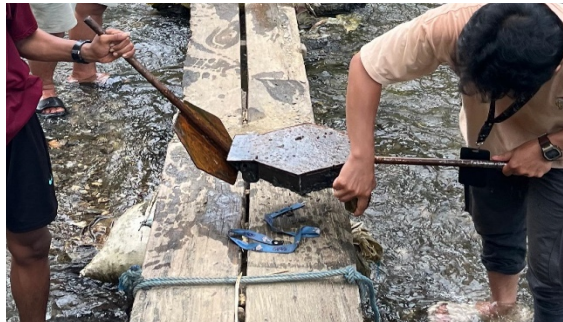
Gambar 5. Pelepasan paving block dari Cetakan
