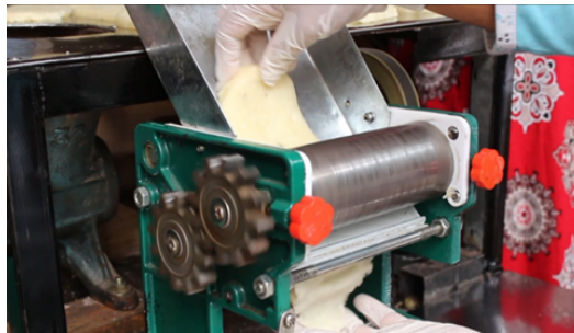
Gambar 9. Proses Pemipihan Singkong Menggunakan Mesin
